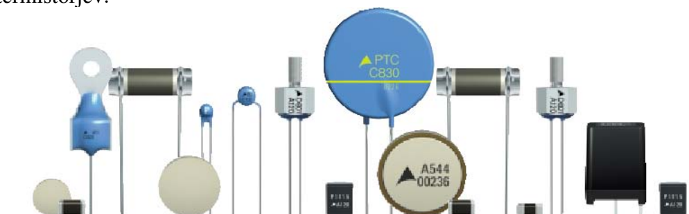
Slika 11: Tipične izvedbe NTK in PTK uporov
