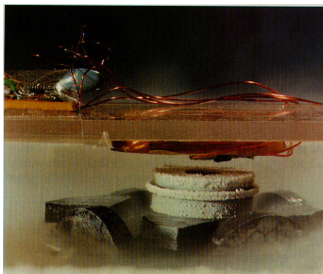
Slika 4.9.9: Uležajenje rotorja motorja s pomočjo superprevodnika
