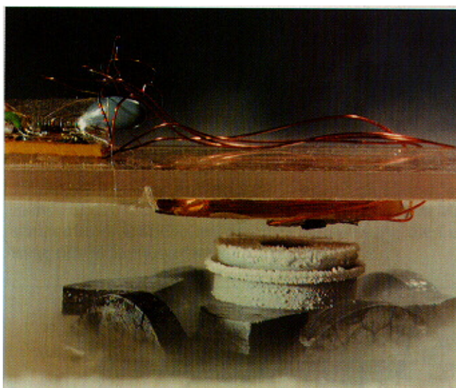
Slika 4.9.9: Uležajenje rotorja motorja s pomočjo superprevodnika
